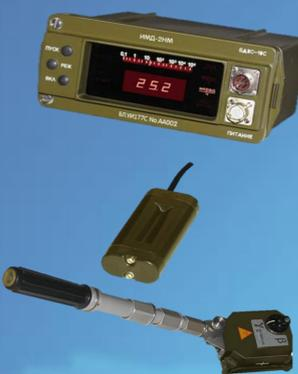
предназначен для измерения мощности поглощенной дозы гамма-излучения, а также степени радиоактивного заражения объектов и местности по гамма, бета-излучению при ведении пешей разведки подразделениями; измерения мощности дозы гамма-излучения, в диапазоне энергии от 0,08 до 3,0 МэВ (от 10 до 999 рад/ч); определения степени радиоактивного заражения местности, военной техники и объектов; измерения плотности потока бета-излучения в диапазоне энергий бета-спектра от 0,3 до 3,0 МэВ.
