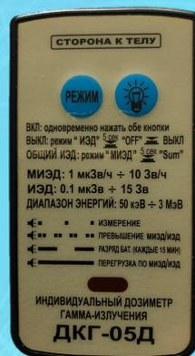
предназначен для измерения индивидуального эквивалента дозы (ИЭД) и мощности индивидуального эквивалента дозы (МИЭД) фотонного излучения.
