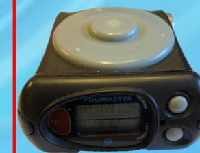
предназначен: для измерения индивидуальной эквивалентной дозы (ЭД) и мощности индивидуальной эквивалентной дозы (МЭД) гамма- и рентгеновского излучений; передачи информации, накопленной и сохраненной в энергонезависимой памяти, по инфракрасному каналу (ИК) связи в ПЭВМ с помощью адаптера ИК (встроенному или внешнему). Диапазон измерения МЭД РМ1621А от 0,1 мкЗв/ч до 1 Зв/ч.
