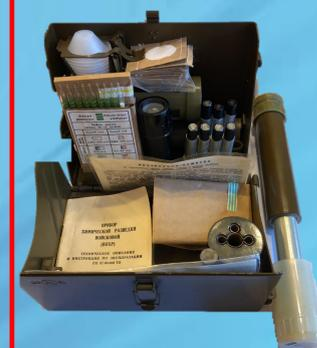
предназначен для определения в воздухе, на местности, на боевой технике отравляющих веществ (ОВ). В состав ВПХР входят: ручной насос; плечевой ремень; защитные колпачки к насосу; насадка к насосу;
